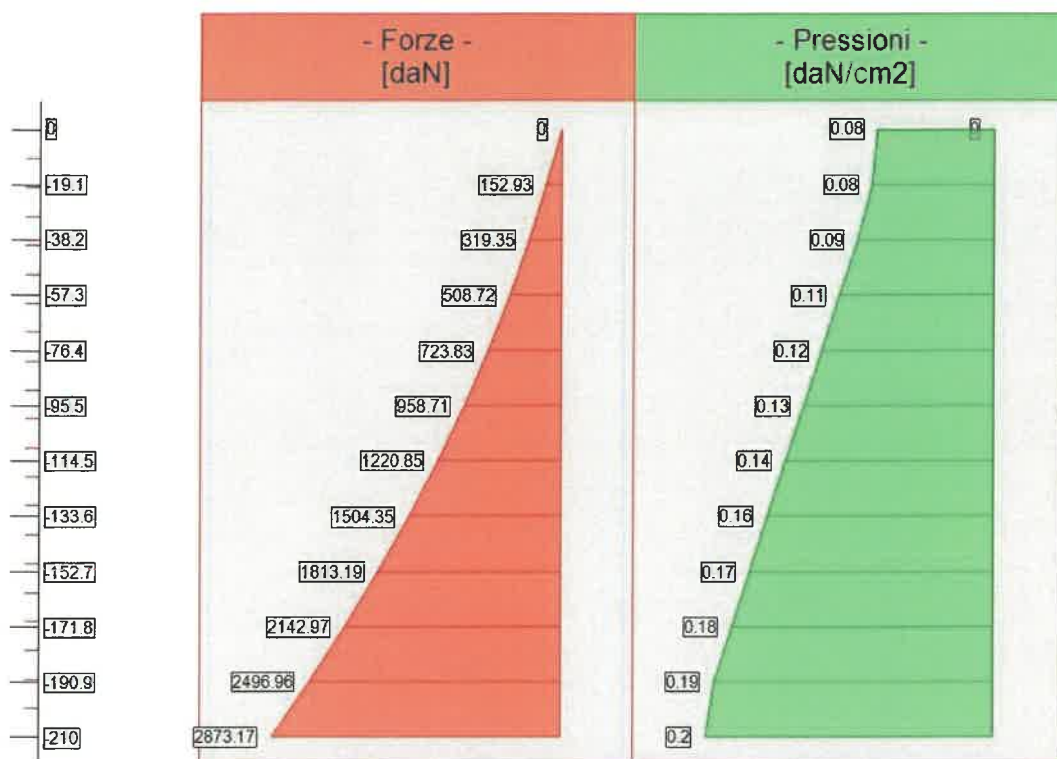
Forze (totali) e Pressioni lungo il fusto, per il Caso 7 ( RARA [ Caratteristica ] - SLE caratteristica (rara) )
